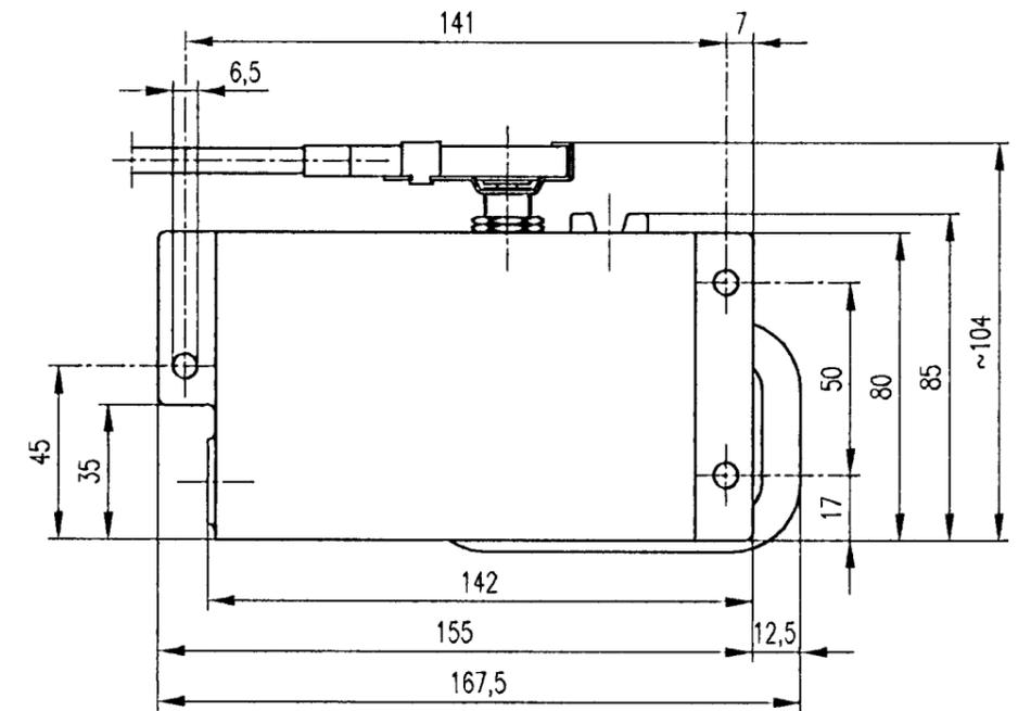
Kennzeichnung der Rückstellungseinrichtung nach UIC 545, Anlage 4, Abb. 1
